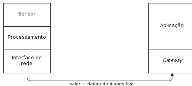
Figura 3.3: Arquitetura em camadas para a comunicação sensor-base
